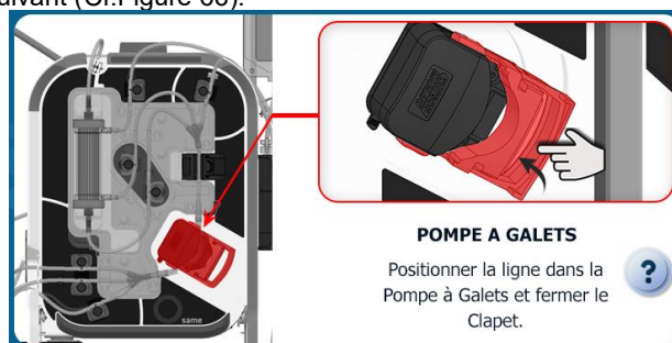
Figure 66 : IHM installation pompe à galets
