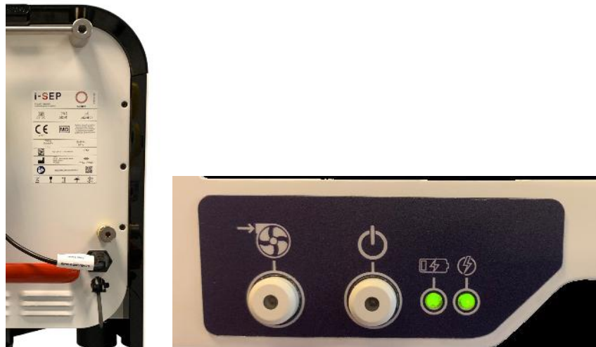
Figure 150 : Connexion du SAT au secteur
