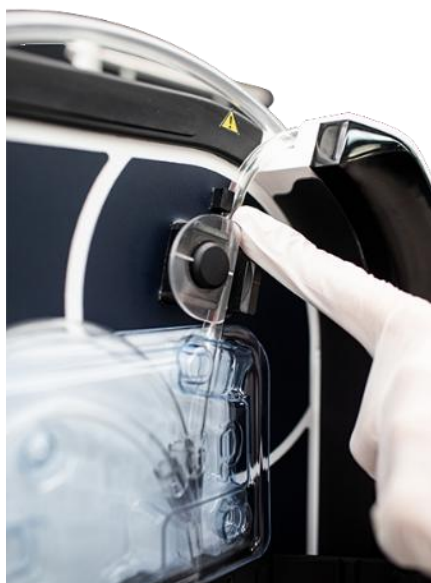
Figure 69 : Capteur de la ligne de réinjection
