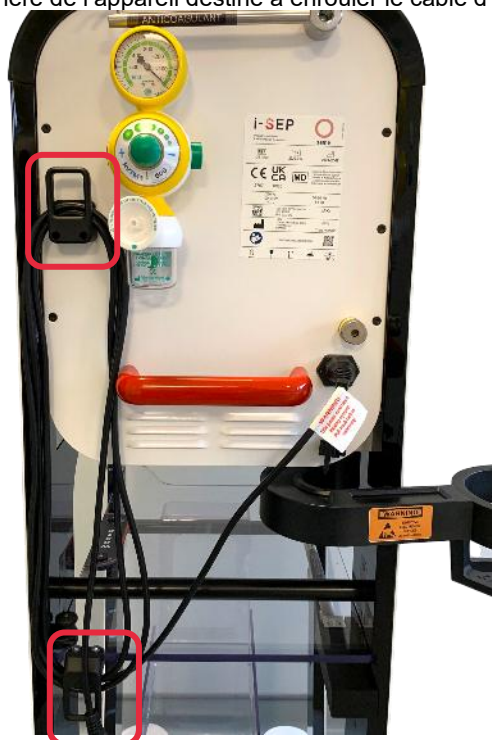
Figure 30 : Taquets pour rangement câble d'alimentation
