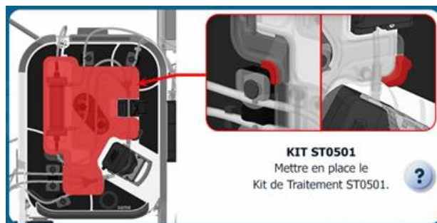
Figure 51 : IHM installation kit de traitement
