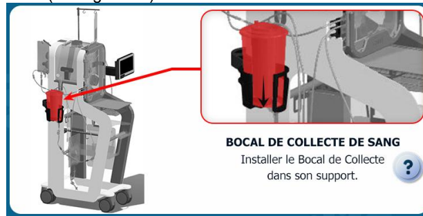
Figure 42 : IHM installation bocal de collecte
