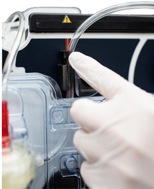
Figure 78 : Installation tubulure capteur déchets
