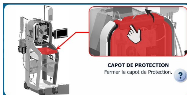
Figure 88 : IHM installation Fermeture du capot de protection
