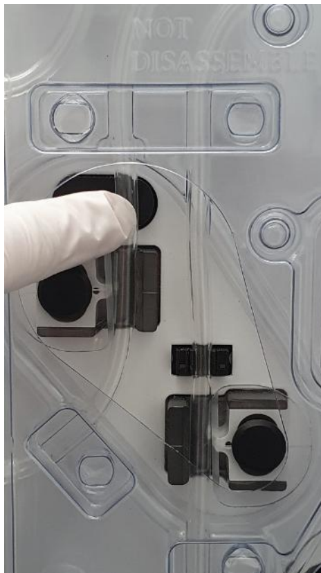
Figure 65 : Installation capteur de pression
