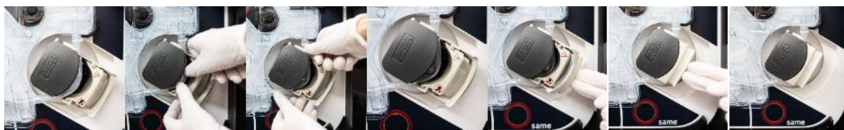
Figure 67 : Installation tube dans la pompe à galets
