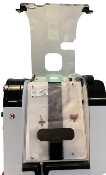
Figure 58 : Installation poche de traitement
