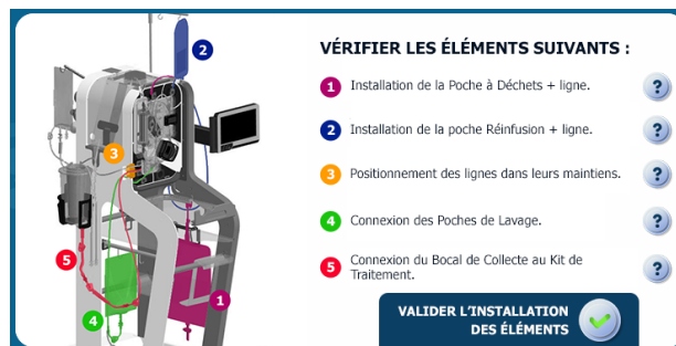
Figure 79 : IHM installation des éléments non détectables
