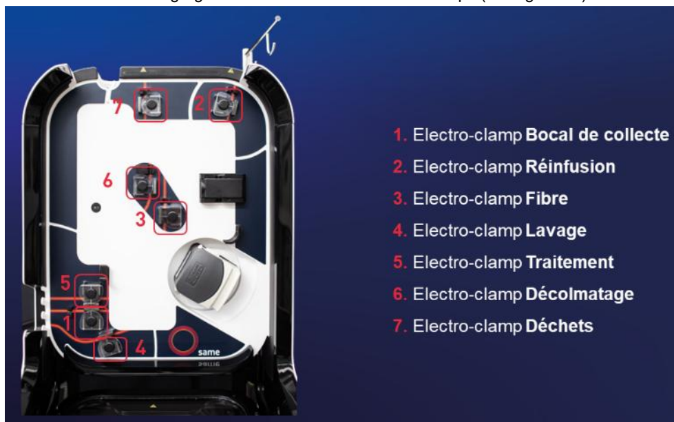
Figure 84 : Installation des électro-clamps
