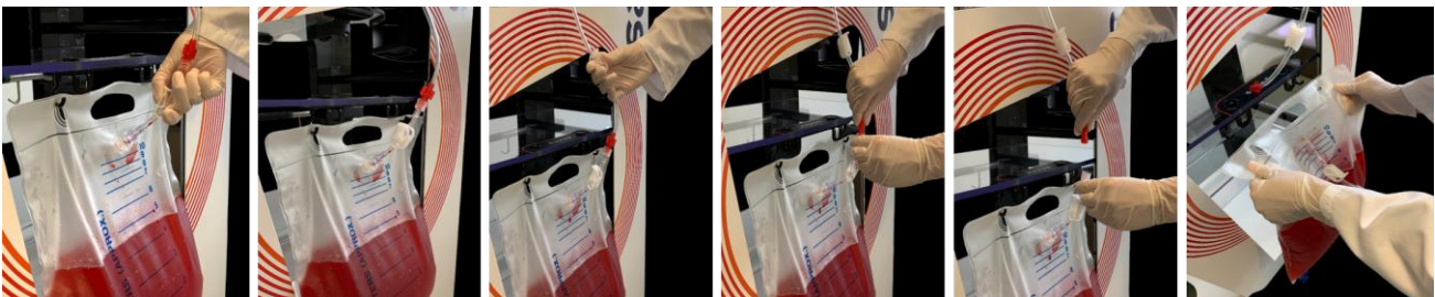
Figure 4 : Remplacement de la poche à déchets BW1000
