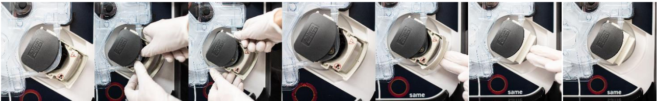
Figura 12: Installazione del tubicino di ripartizione dei flussi nella testata della pompa
