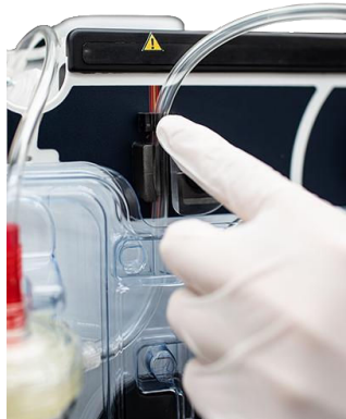
Figura 21: Inserimento del tubicino nel sensore Rifiuti
