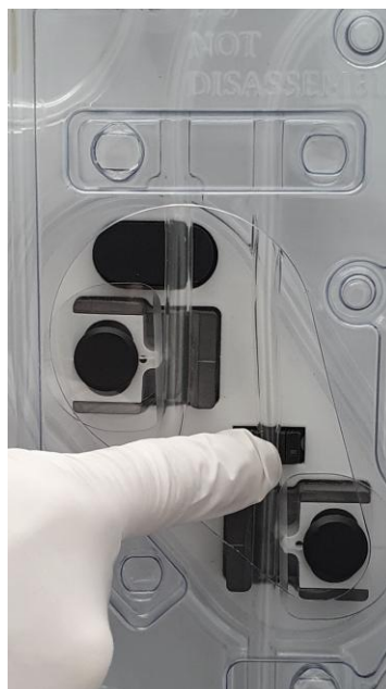
Figura 10: Inserimento del tubicino nel sensore Fibra IN
