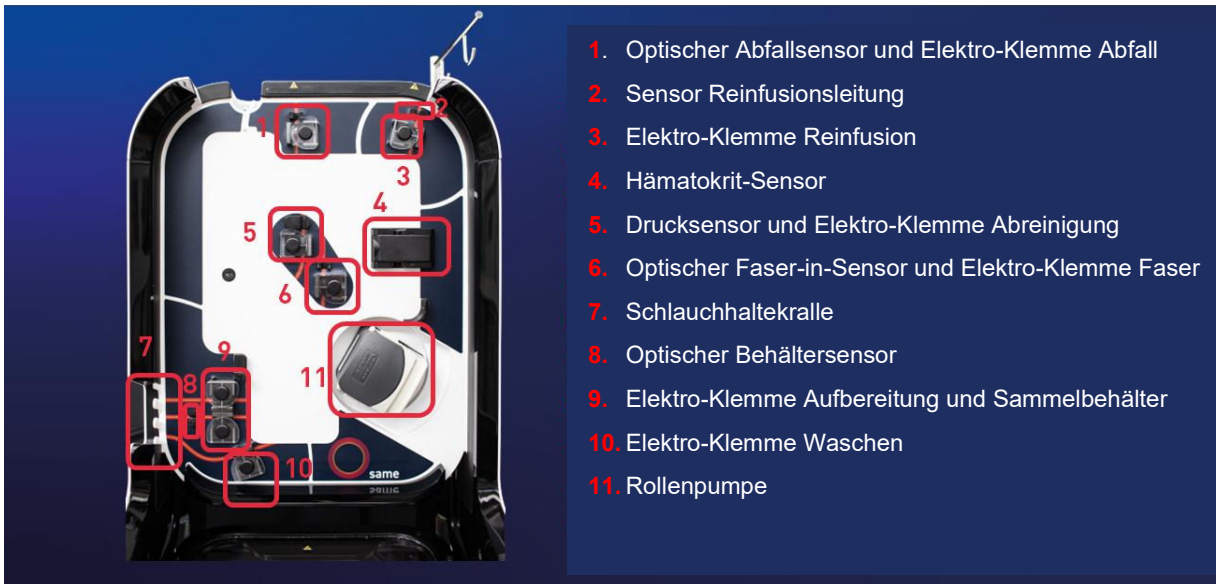
Abbildung 5: Kontrolle der Installation
