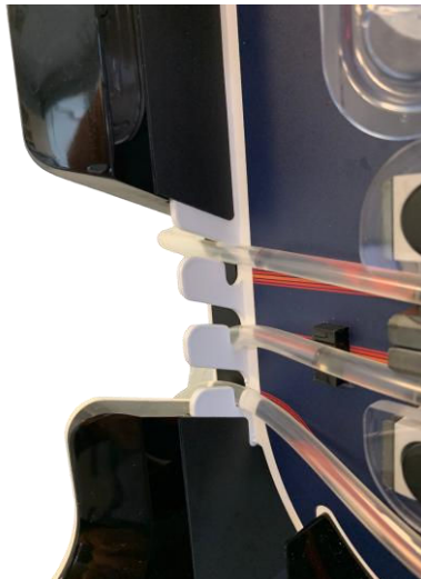
Abbildung 15: Installation der Schläuche in der Kralle
