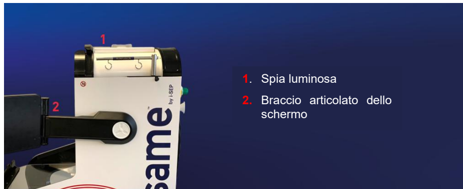
Figura 8: Vista del lato destro del SAT
