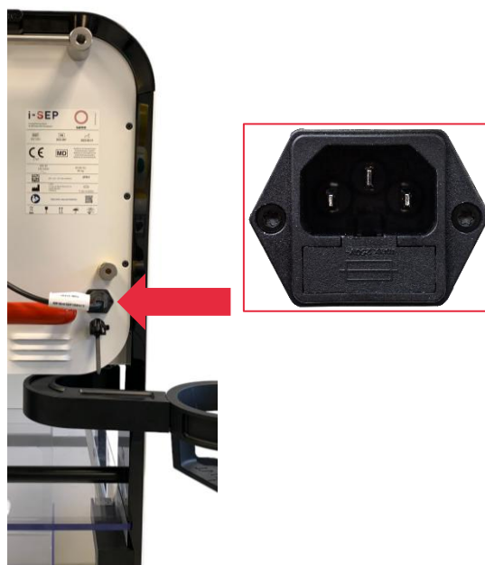
Figura 32: Collegamento alla rete elettrica
