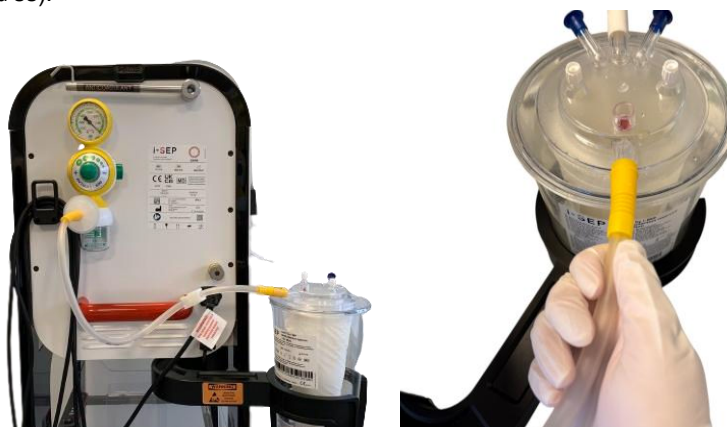
Figura 88: Installazione del vuoto per l'aspirazione
