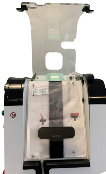
Figura 54: Installazione della sacca di trattamento
