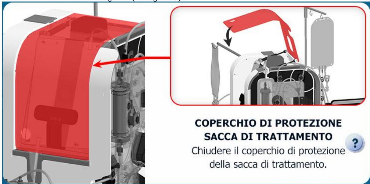
Figura 56: Chiusura del coperchio di protezione della sacca di trattamento
