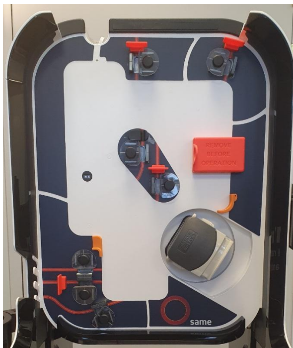
Figura 30: Coprisensori a protezione dei sensori ottici
