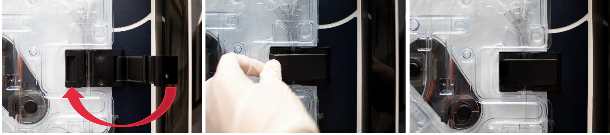
Figura 68: Chiusura della valvola a lamelle del lettore dell'ematocrito
