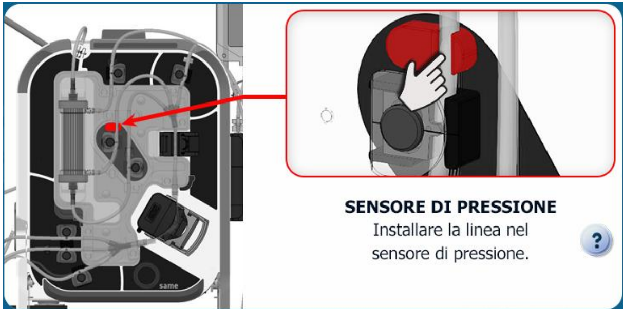
Figura 60: HMI - installazione del sensore di pressione
