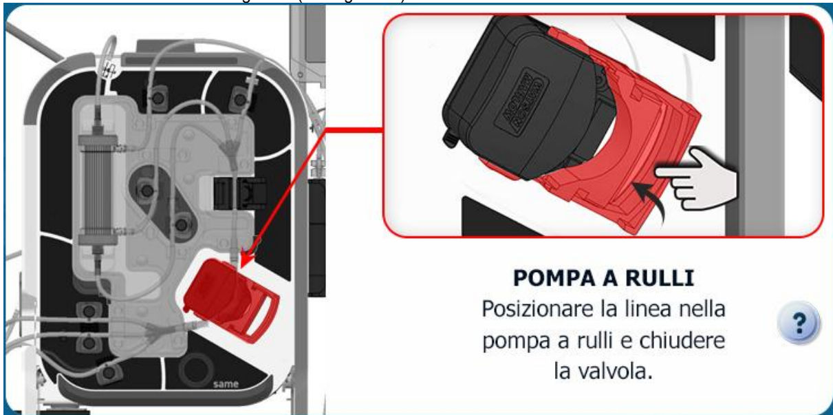
Figura 62: HMI - installazione della pompa a rulli
