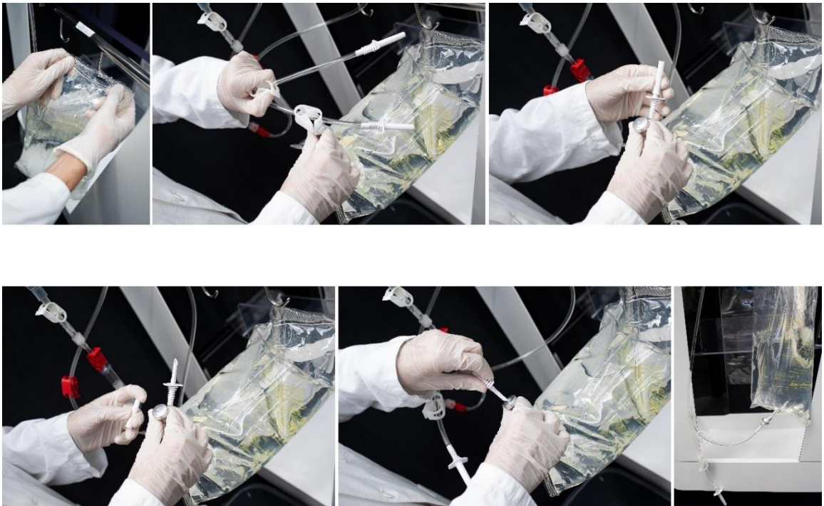
Figura 72: Installazione della sacca di lavaggio
