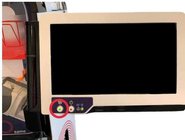
Figura 37: Pulsante di avvio / arresto della pompa per il funzionamento dell'aspirazione
