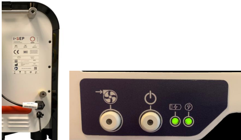
Figura 146: Collegamento del SAT alla rete elettrica
