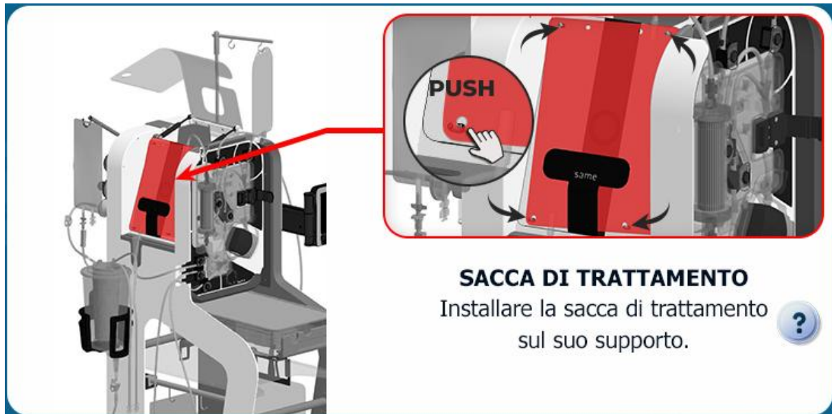
Figura 53: HMI - installazione della sacca di trattamento
