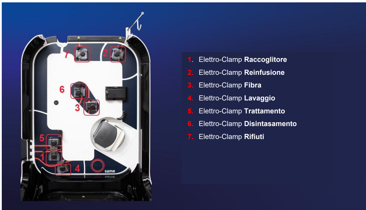
Figura 14: Zona di trattamento
