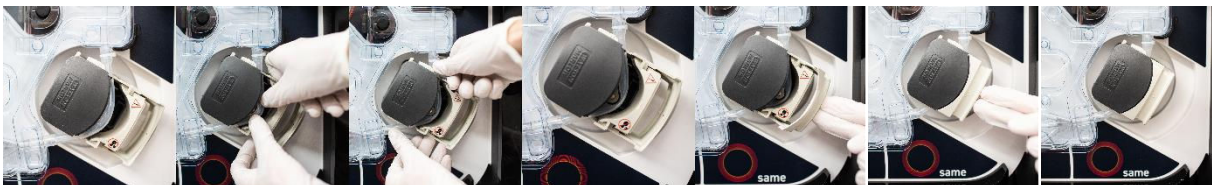
Figura 63: Inserimento del tubicino nella pompa a rulli
