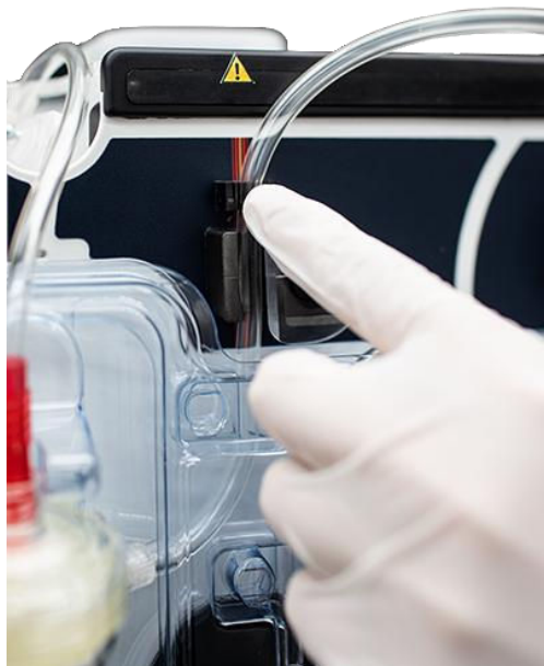
Figura 74: Inserimento del tubicino nel sensore Rifiuti
