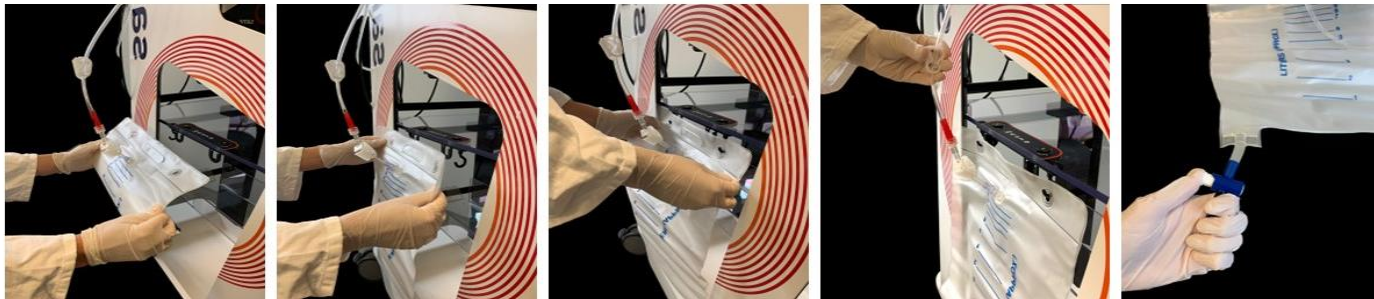
Afbeelding 2: Installatie van de afvalzak van de BW1000 (1/2)
