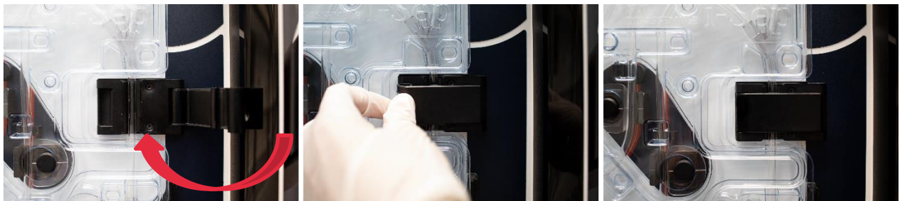
Afbeelding 11: Plaatsing van de buis in de hematocrietlezer
