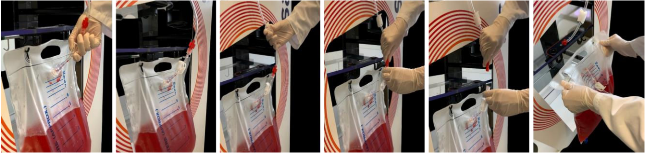
Figur 4: Udskiftning af i-SEP-affaldsposen
