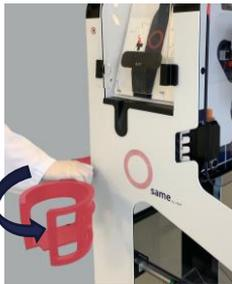
Die Halterung für den Sammelbehälter hinten an der Maschine ausklappen.
