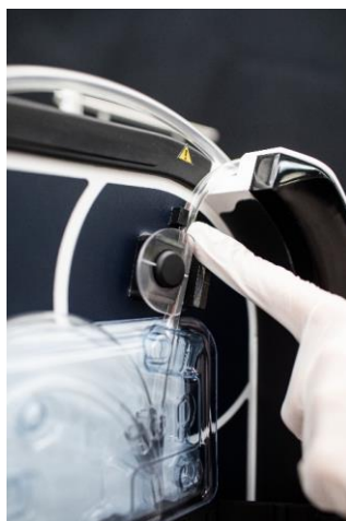
Figure 16 : Capteur de présence ligne de réinfusion
