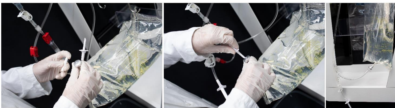
Figure 14 : Installation de la poche de lavage
