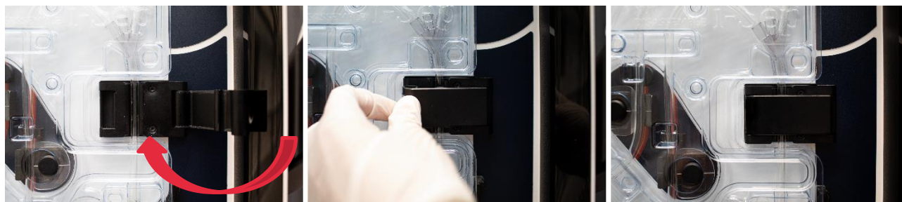
Figure 11 : Mise en place de la tubulure dans le lecteur d'hématocrite
