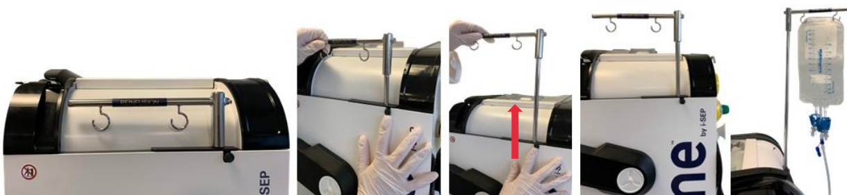
Figure 15 : Installation de la poche de réinfusion
