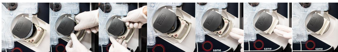
Figure 10 : Mise en place de la tubulure de répartition des flux dans la tête de pompe
