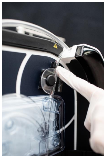
Obrázek 16: Snímač přítomnosti re-infuzní linky
