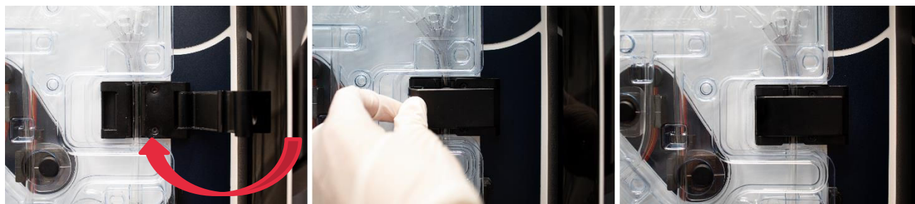
Obrázek 11: Vložení hadičky do čtečky hematokritu
