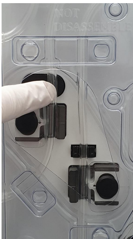
Figur 57: Installation av slangen i den trycksensor
