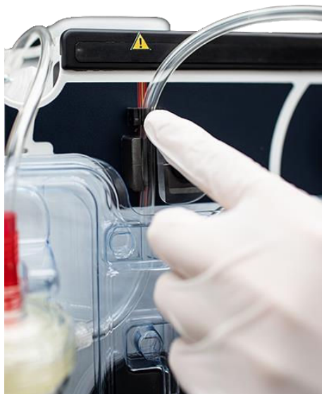
Figur 74: Installation av slangen i den avfallssensorn
