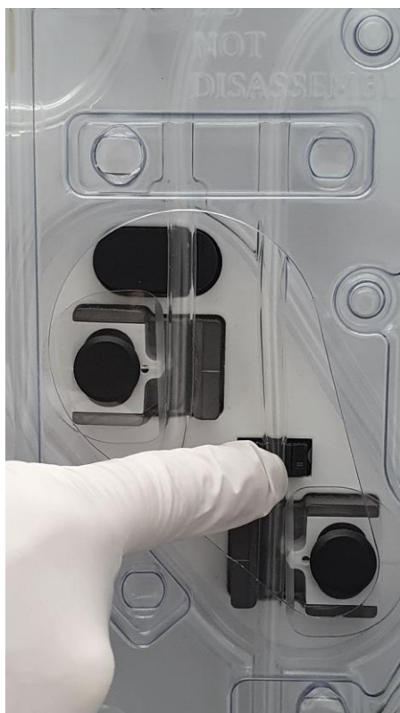
Figur 55: Installation av fiber IN-slangen
