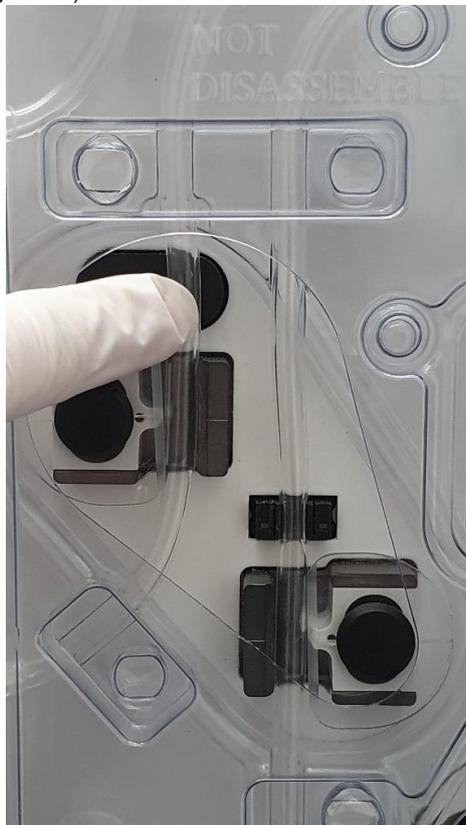
Figure 57 : Installation capteur de pression
