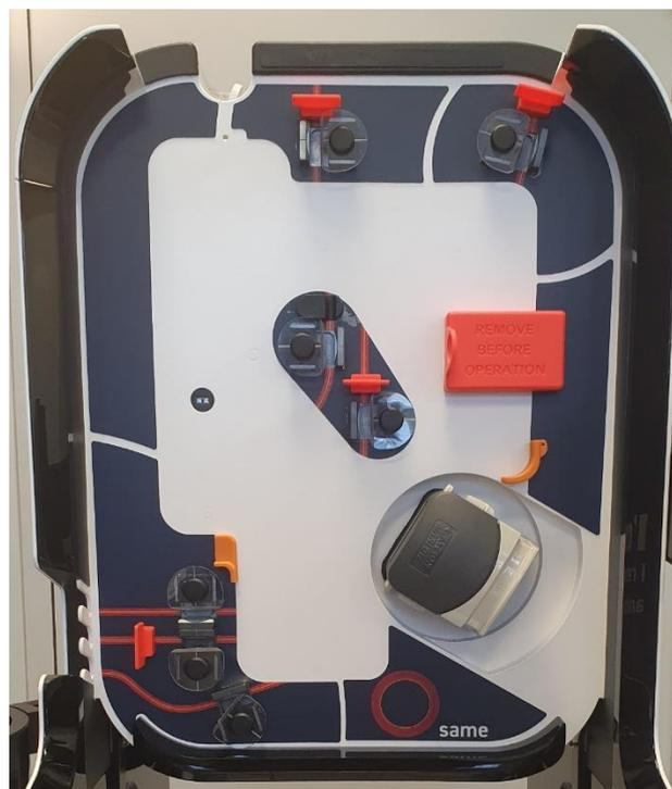
Figure 138 : Caches sur capteurs optiques
