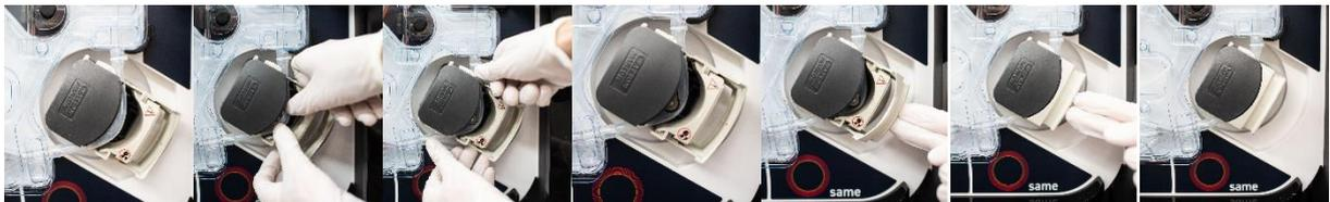
Figure 59 : Installation tube dans la pompe à galets
