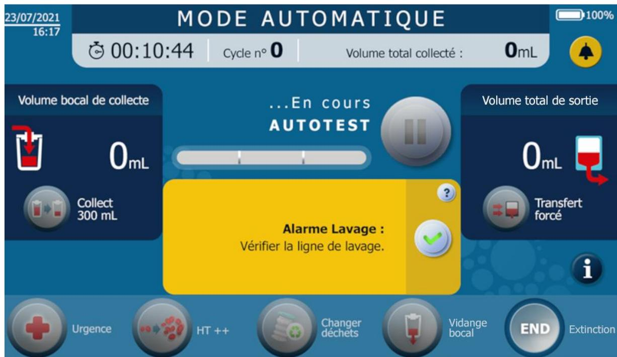
Figure 117 : Ecran lorsque la machine détecte que la poche de lavage doit être changée
