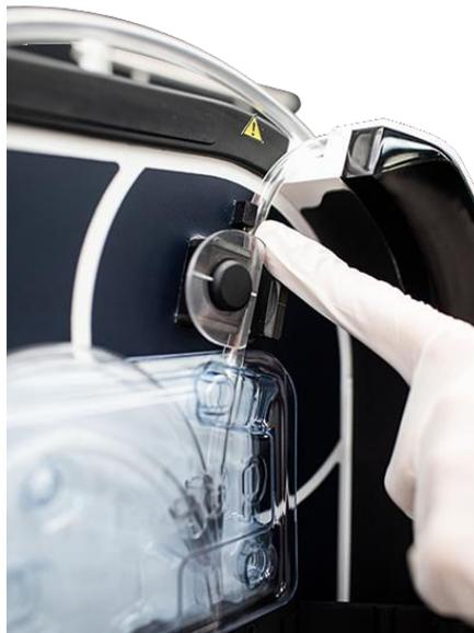
Figure 61 : Capteur de la ligne de réinjection
