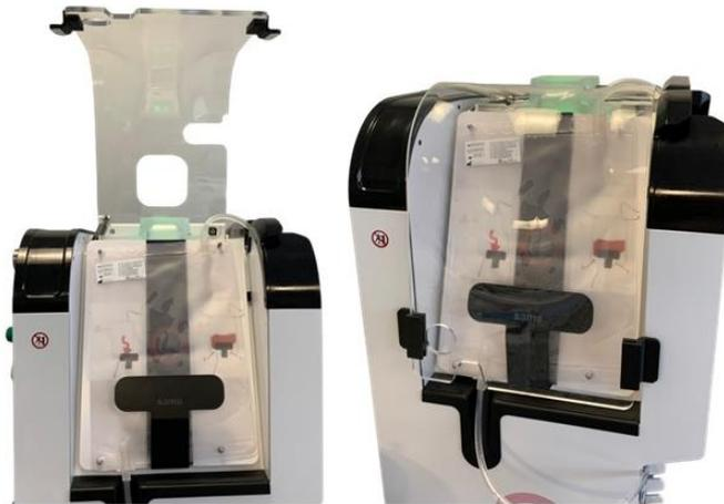
Figure 53 : Capot de protection de la poche de traitement ouvert et fermé
