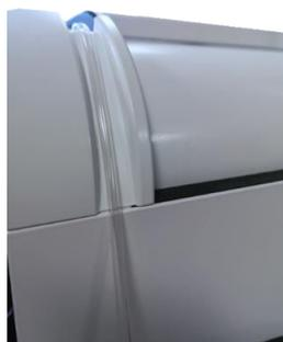
Figure 79 : Insertion de la ligne de réinjection dans le guide tube
