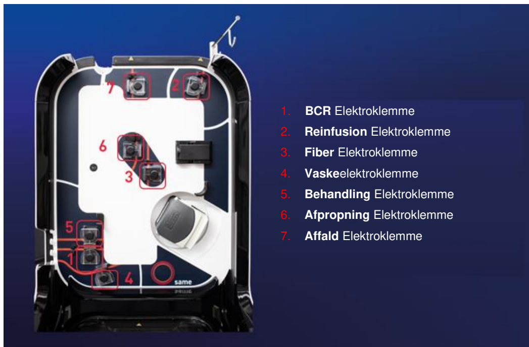
Figur 80: Installation af elektroklemmer
