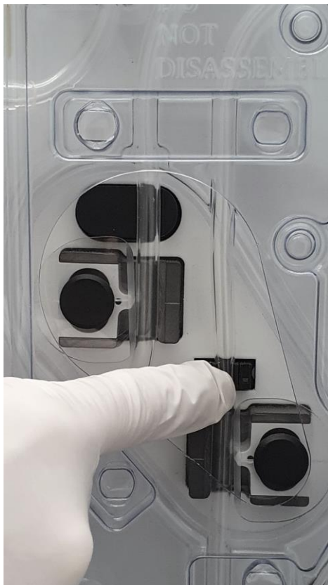
Obrázek 55: Instalace senzorového potrubí Fibre IN
