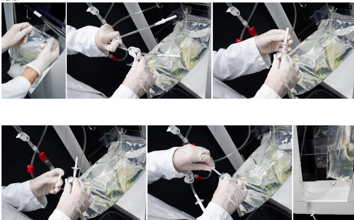
Obrázek 72: Instalace promývacího vaku
