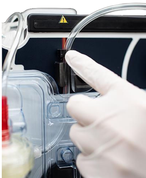
Obrázek 74: Instalace potrubí sběrače odpadu
